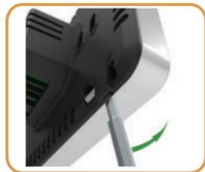
Trennen Sie die Platte vom hinteren Teil: Führen Sie den Schraubendreher in zwei Löcher unter dem Thermostat ein und hebeln Sie ihn wie auf dem Bild ab.
